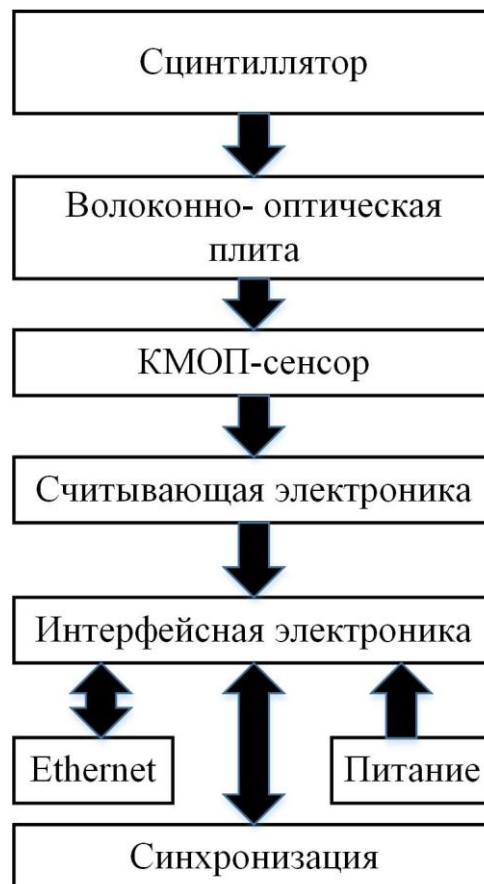
Рис.1. Схема цифрового детектора
