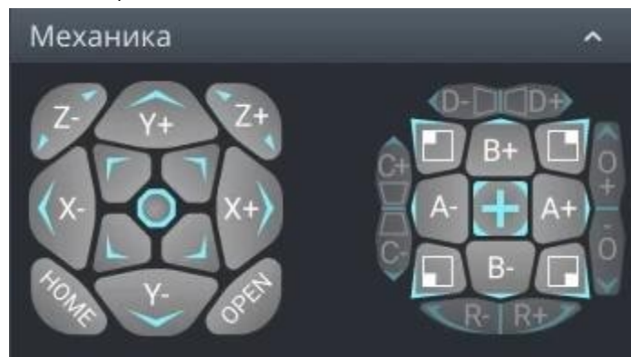
Рисунок 5.14 – Окно управления системой перемещения
